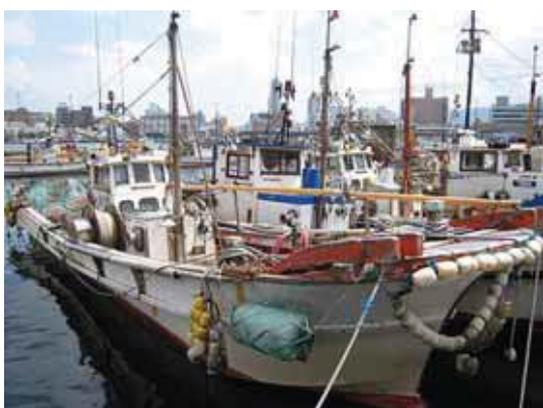
これはある地域の小型底びき網漁船で、3トン未満の非常に小さい船です。この船では、網の端に付いているワープと呼ばれるロープを繰り出す、あるいは巻き取ることで網を操作します。しかし、ワープを巻き取るウィンチがブリッジの脇に迫り出すように装着されています。本来、ブリッジの脇は人が歩く通路ですが、ウィンチでふさがれているため、漁業者はブルワークと呼ばれる船の縁の上を歩かなくてはならず、海中転落の危険があります。
