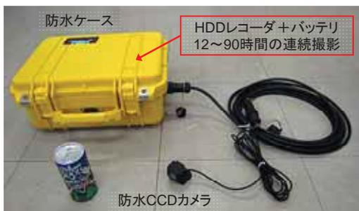
撮影装置というのは、ほとんど存在しません。そこで私は、市販の CCD カメラやレコーダー、防水ケースなどを組み合わせた、船上作業撮影装置を自作しています。画質の設定や使用する電池などにもよりますが、最大で3~4日程度の連続撮影ができます。このような装置を活用して、船上作業を細大漏らさずビデオ資料にすることが、船上作業評価のベースとなります。
