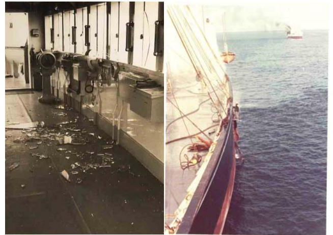
写真3. 船橋の惨状—フロントガラス破損（左） 被弾箇所—外側に捲れる外板（右） 遠くに同じく被弾炎上の船が見える 出典：関野三彦船長、1993『山城丸炎上—あれから20年—』 p.56（左）、61（右）。
