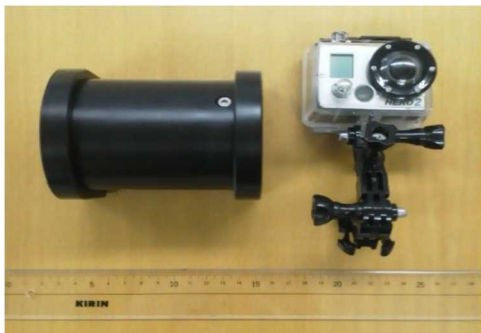
図 1. 小型データロガーとウェアラブルカメラ
