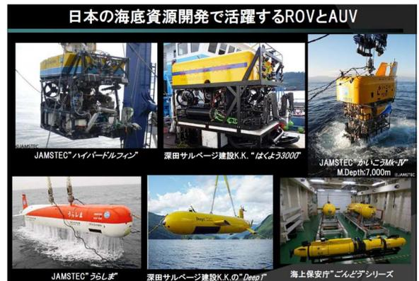
図 3. 日本の海底資源開発で活躍する ROV と AUV
